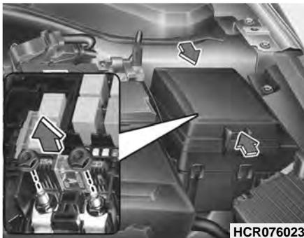
Перегоревший мультипредохранитель извлекают следующим образом:
