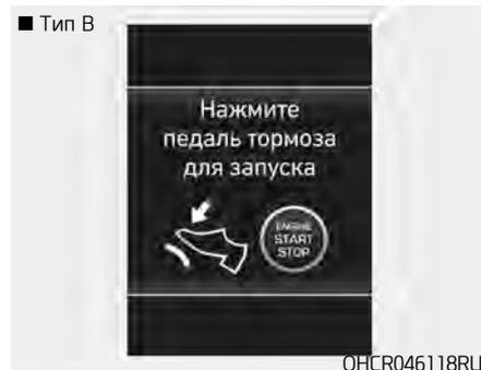
Это предупреждающее сообщение отображается, если кнопка пуска/остановки двигателя нажата в положение АСС дважды без нажатия педали тормоза. Двигатель можно запустить после нажатия педали тормоза.
