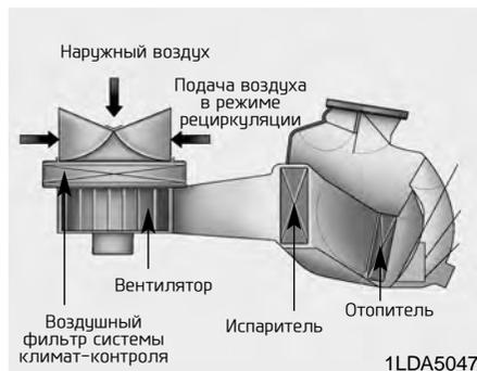
Воздушный фильтр климат-контроля установлен за перчаточным ящиком и предназначен для очистки поступающего в салон воздуха от пыли или других загрязнителей, поступающих с наружным воздухом через систему кондиционирования. С течением времени фильтр забивается, что вызывает уменьшение воздушного потока через вентиляционные каналы и, как следствие, к скоплению влаги на
