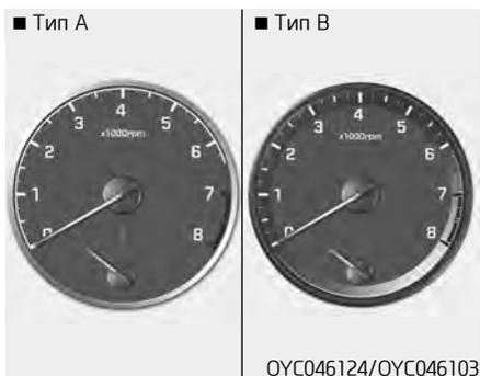
На тахометре отображается частота вращения коленчатого вала двигателя в оборотах в минуту (об/мин).
