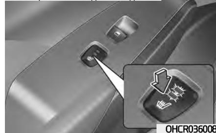
При работающем двигателе включите обогреватель сиденья водителя или пассажира.
