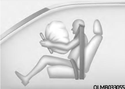
После срабатывания происходит разрыв швов мягкой крышки, которая отделяется под давлением при расширении подушек безопасности. Последующее открытие крышек позволяет полностью раскрыться подушкам безопасности.
