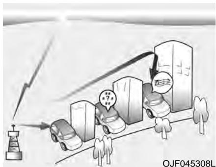
АМ и FM радиосигналы передаются с высотных радиопередатчиков, расположенных вокруг города. Они улавливаются радиоантенной вашего автомобиля. Затем этот сигнал передается радиоприемником в динамики автомобиля.
