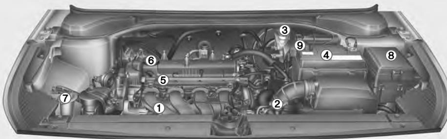
1. Расширительный бачок для охлаждающей жидкости двигателя
