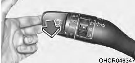
Для мигания дальним светом фар следует потянуть рычаг на себя и отпустить. Дальний свет отстаетя включенным, пока не отпущен рычаг.
