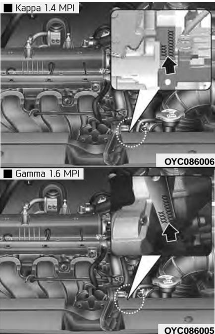
Серийный номер двигателя выштампован на блоке цилиндров, как показано на рисунке.
