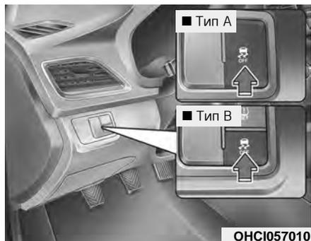
Электронная система динамической стабилизации (ESC) способствует сохранению устойчивости автомобиля на поворотах.
