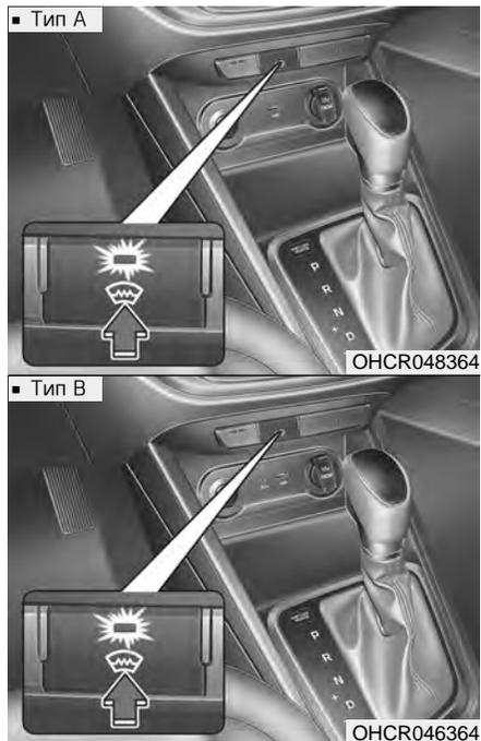
При работающем двигателе обогреватель нагревает ветровое стекло изнутри и снаружи для устранения инея, запотевания и ледяного налета.
