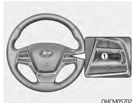
3. Толкните рычаг (1) вниз (к SET-) и отпустите его. Загорится индикатор SET или установленная скорость на панели приборов.
