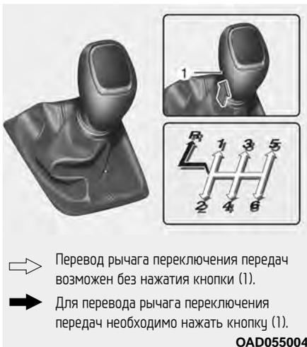
В механической коробке передач предусмотрено 6 передач переднего хода. Трансмиссия полностью синхронизирована на всех передачах переднего хода, поэтому переключение легко осуществляется как на повышенные, так и на пониженные передачи.
