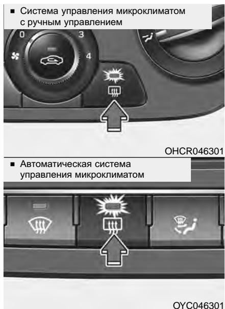
При работающем двигателе обогреватель нагревает заднее окно изнутри и снаружи для устранения инея, запотевания и ледяного налета.
