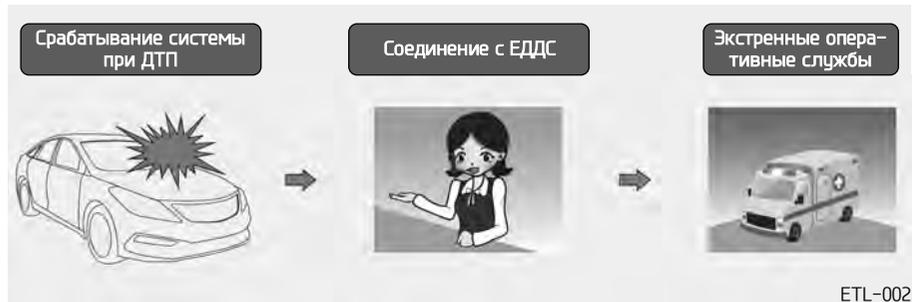
Устройство ЭРА-ГЛОНАСС автоматически совершает экстренный вызов в единую дежурно-диспетчерскую службу для своевременного выполнения действий по спасению, при дорожно-транспортном происшествии с участием автомобиля.
