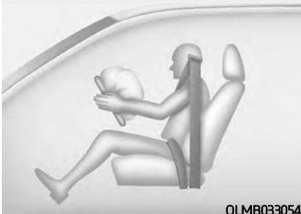
Когда блок управления подушками безопасности обнаруживает достаточно серьезный удар в переднюю часть транспортного средства, он автоматически надувает передние подушки безопасности.
