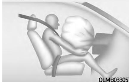
После полного раскрытия подушка сразу же начинает сдуваться, обеспечивая водителю видимость и возможность управления транспортным средством в случае необходимости.
