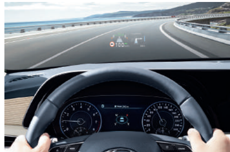
Алдыңғы айнекке аспаптар көрсеткіштерінің проекциясы
